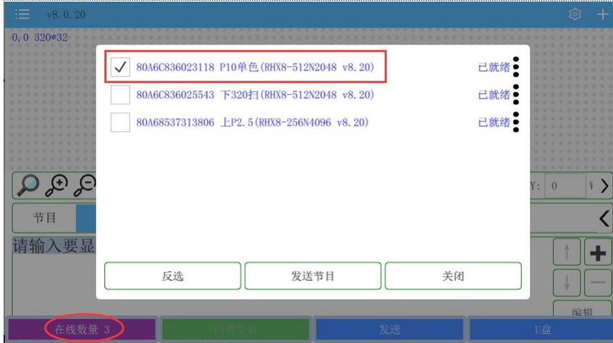
**第二步，屏参实时同步、手动设置屏参。**点击右上角“齿轮”进入设置屏参，选择对应显示屏的控制卡类型及参数信息，通信方式选择“网络”。下面以全彩屏为例：扫描序号一般选择第 2 个（全彩默认 41 扫）；宽度和高度改成显示屏的实际尺寸（观察显示屏变法、实时同步当前设置的尺寸——显示屏周围有完整的花边显示、且无花边和字幕重影，表示屏参设置正确）；最后保存返回即可（其他不用设置，一般默认就行）。
